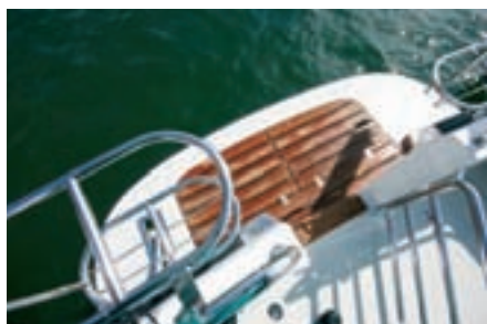
Badeplattform mit Inspektionsluk in der Grätung.
