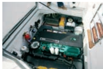
Der Motorraum mit dem Volvo Penta D6 370 DP.
