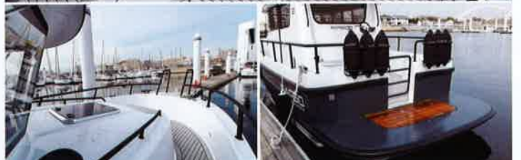
高さのある35mm径のレールに囲われたデッキは走行中も居心地の良いスペース。アフトステーションも備わり使い勝手が良い。フリーボードが高いため、樓梯との行き来は大型スイングプラットフォームから楽だ。
